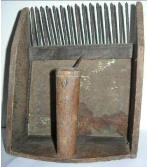
"Heipperstrehl" Marke Eigenbau mit Blechboden. Die Beeren müssen nach dem Lesen mit viel Handarbeit vom Laub gesäubert werden.
