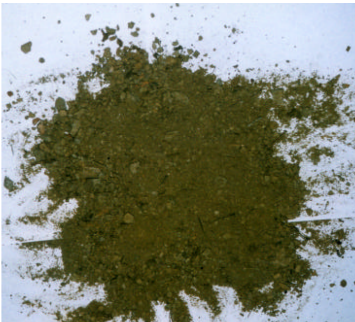
Gebrannter Kalk aus dem Chalchhofen in der Chalchtola, der jetzt gesiebt werden musste, bevor er verarbeitet werden konnte.
